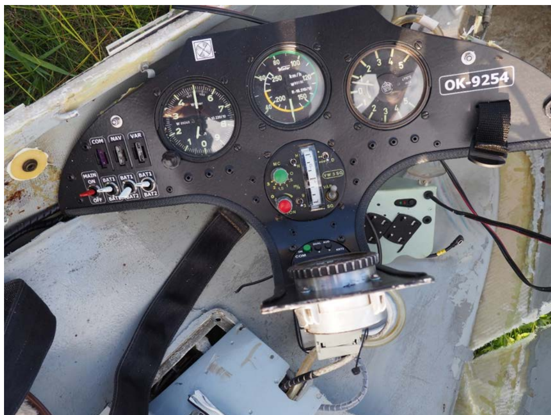
Obr. 9 - Trosky kluzáku na místě dopadu (pohled na přístrojový panel)
