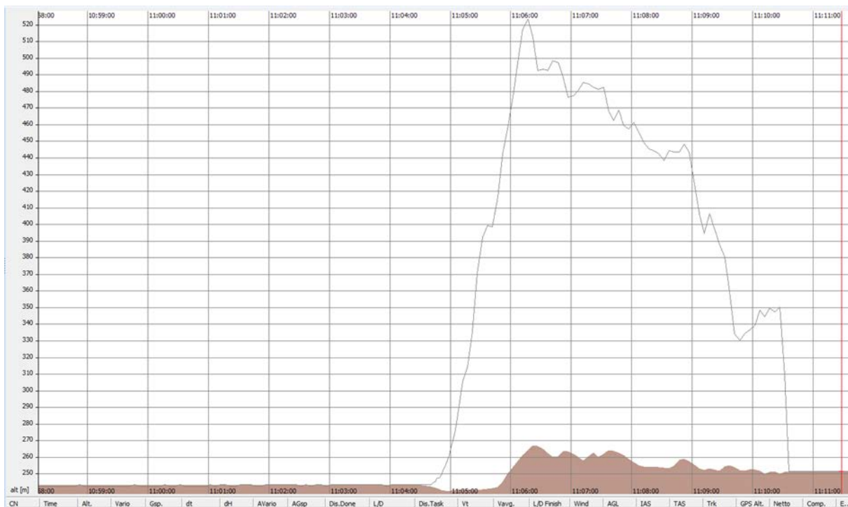
Obr. 12 - Výškový profil kritického letu zaznamenaného GPS letovým zapisovačem ERIXX
