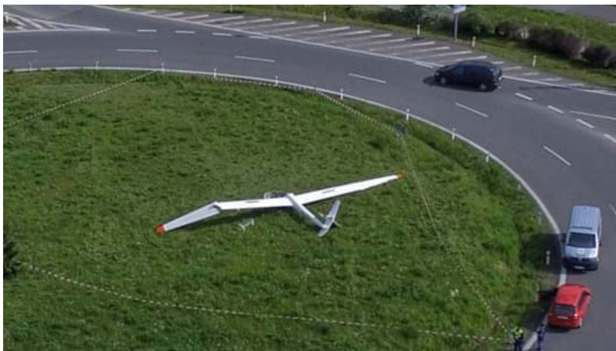
Obr. 4 - Přejít kluzáku do vývrtky s vysunutými vzdušnými brzdami v čase 11:10:32 cca 4'' před dopadem
