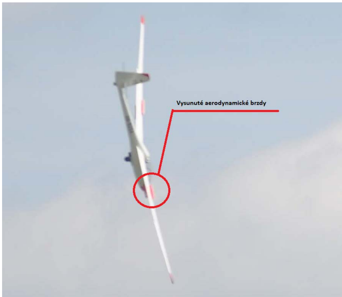
Obr. 4 - Přejít kluzáku do vývrtky s vysunutými vzdušnými brzdami v čase 11:10:32 cca 4'' před dopadem
