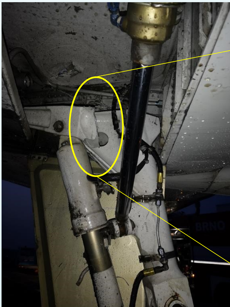
Detail lomu podvozkové nohy.
