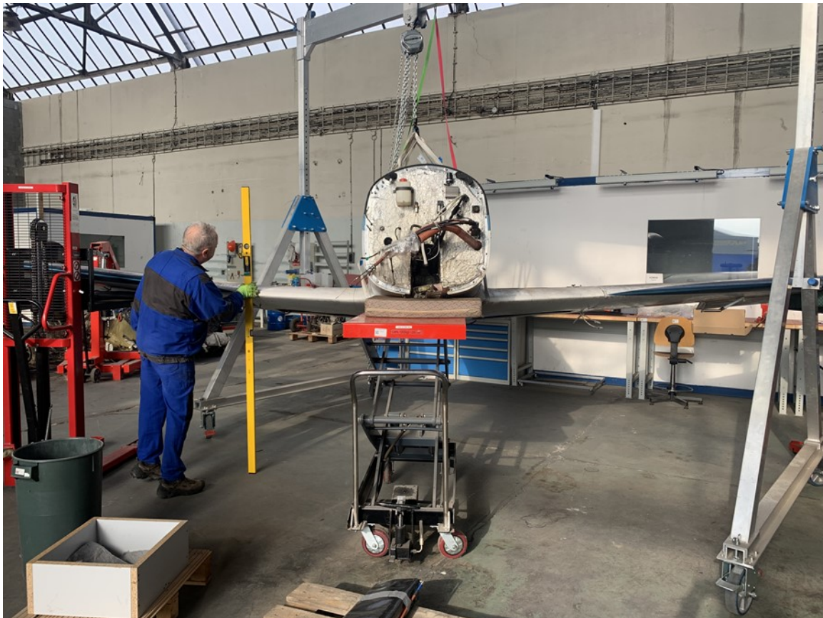
Obr. 9 – Nivelace LŠZ v depozitním prostoru ÚZPLN
