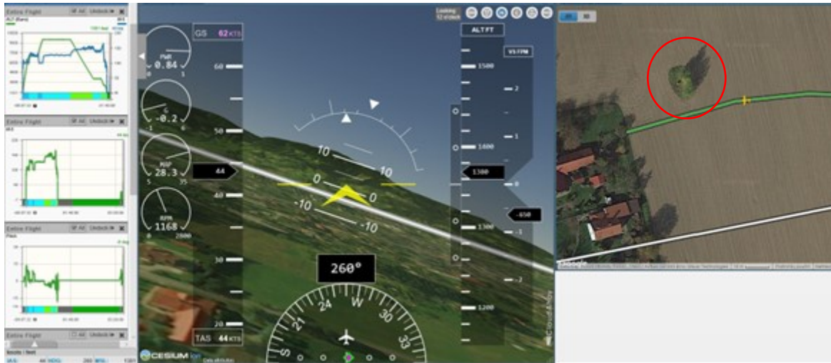
Obr. 9 – IAS 44 / GS 62 KTS 4 Pitch cca 2° / 1380 ALT FT / RPM 1168 / letoun bez rychlosti v levém náklonu provádí manévř k vyhnutí se překážce (strom v červeném kruhu)
