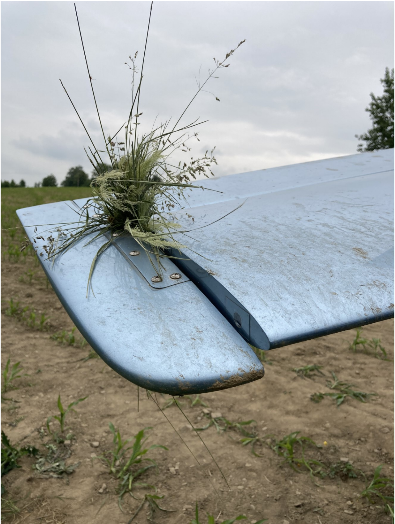
Obr. 1 – Vytržený trs trávy v prostoru mezi kormidlem a stabilizátorem výškového kormidla
