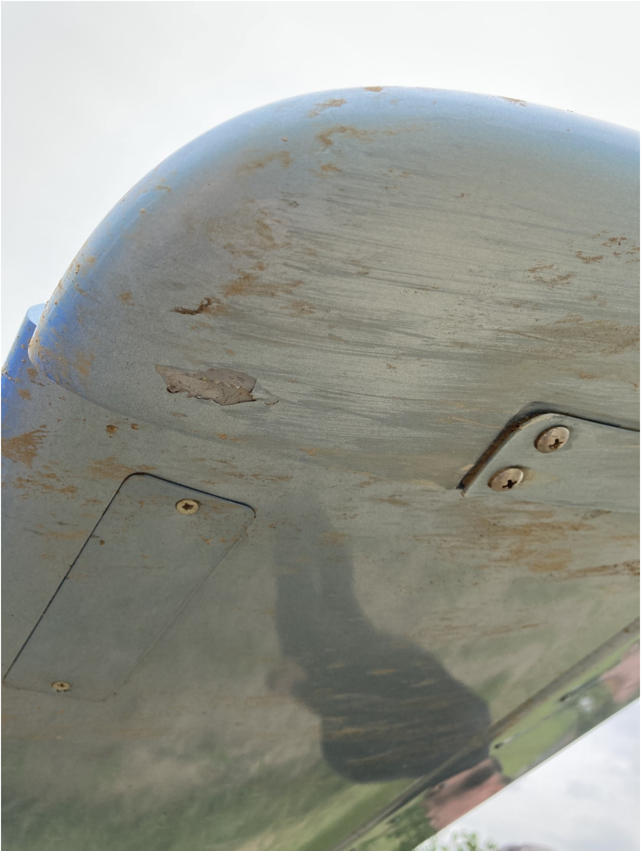
Obr. 2 – Podélné rýhy na aerodynamickém vyvážení výškového kormidla svědčící o kontaktu se zemí při maximální výchylce přetaženého letounu při pokusu o vzlet
