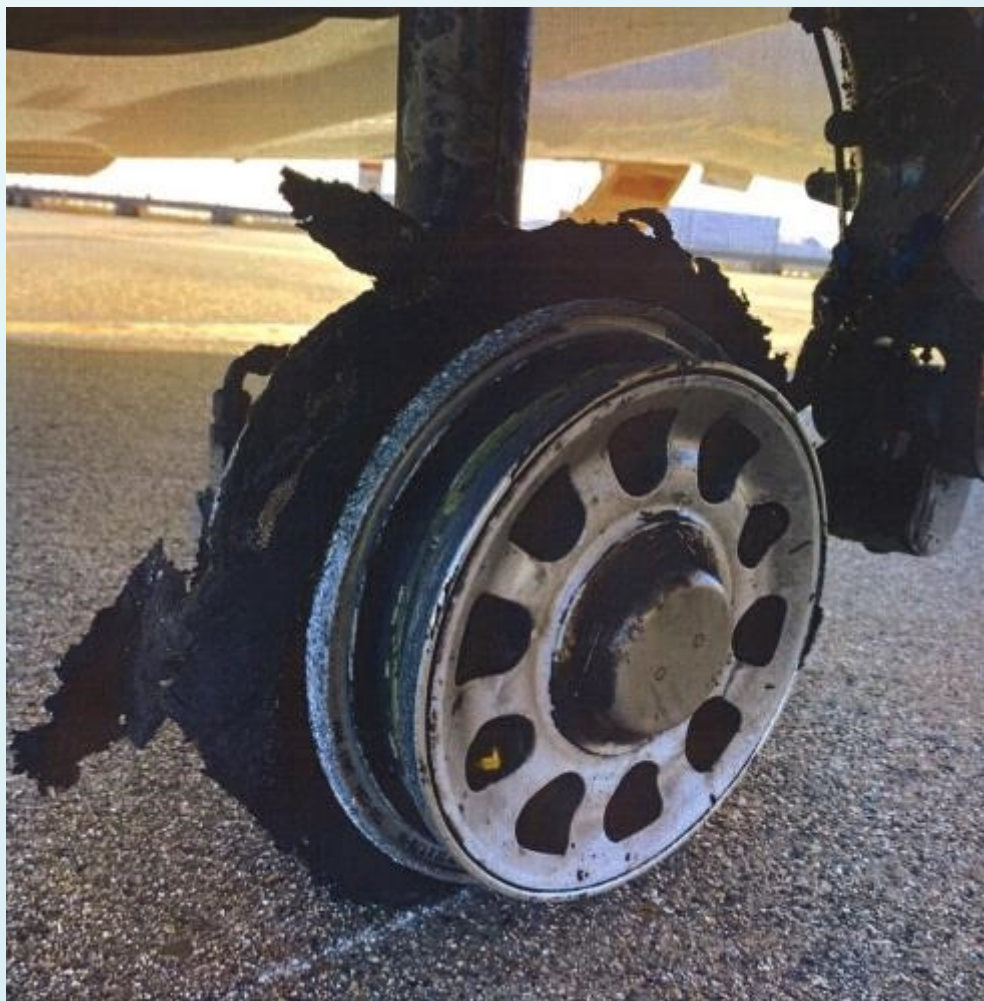
Poškozené podvozkové kolo letounu Cessna 525-A
