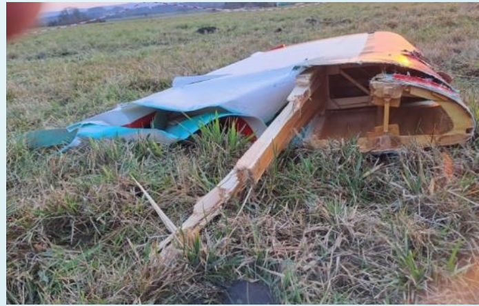
Ulomená část levé poloviny křídla na místě dopadu
