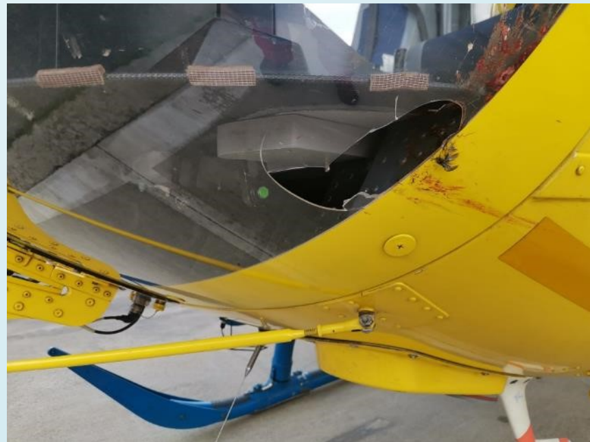
Poškozené spodní okno vrtulníku EC135
