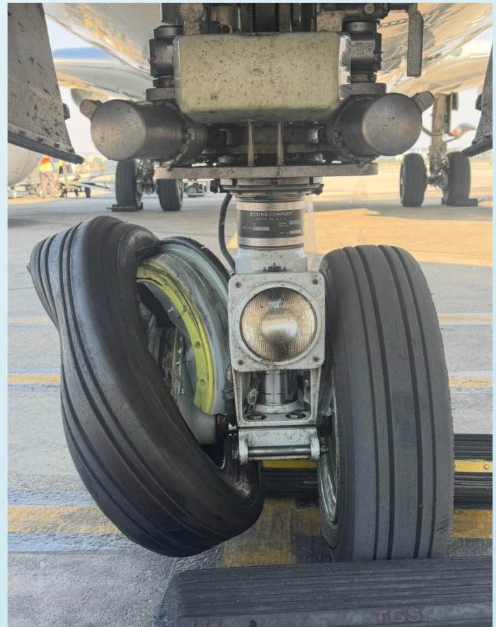
Poškozený disk pravého kola předového podvozku a zničená pneu
