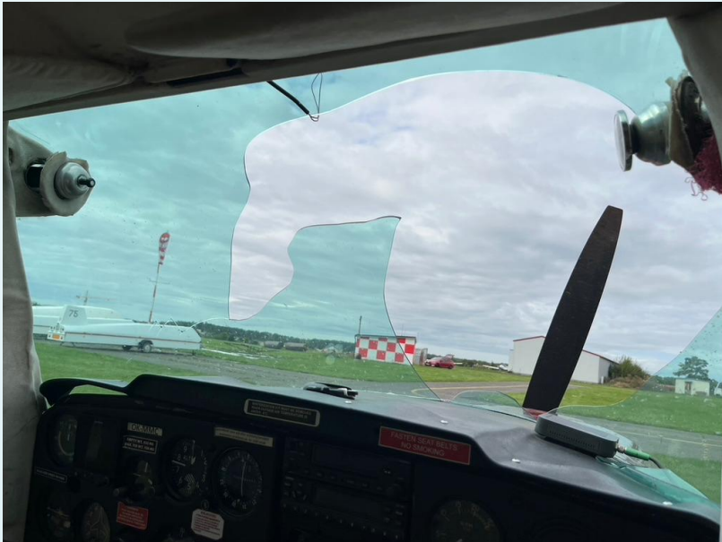
Poškození letounu Cessna 152 a nalezený poštovní holub.
