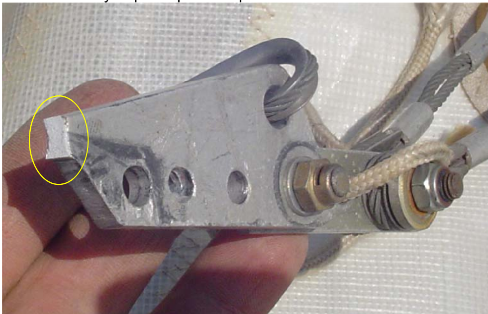
Obr. 4 Ulomený napínák příčnicku po LN
