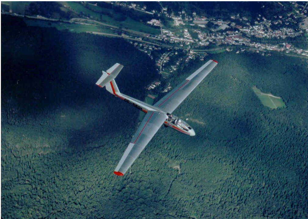
Obr. 4: L-23 Super Blaník je dvoumístný celokovový kluzák hornoplošné konstrukce. Je určen zejména pro pilotní výcvik včetně nácvičku vyšší pilotáže. Posádka: 2 osoby. Ilustrační foto.
