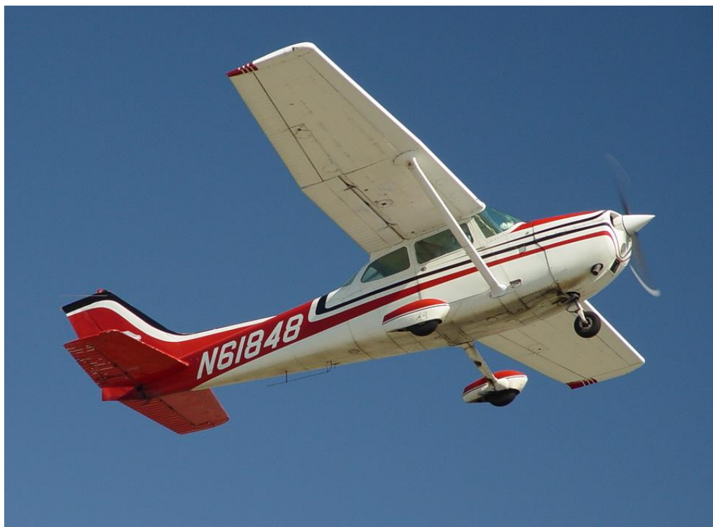
Obr. 2: Cessna 172 Skyhawk je lehký jednomotorový, hornoplošný, čtyřsedadlový letoun, který od roku 1956 vyrábí Cessna Aircraft Company. Ilustrační foto.
